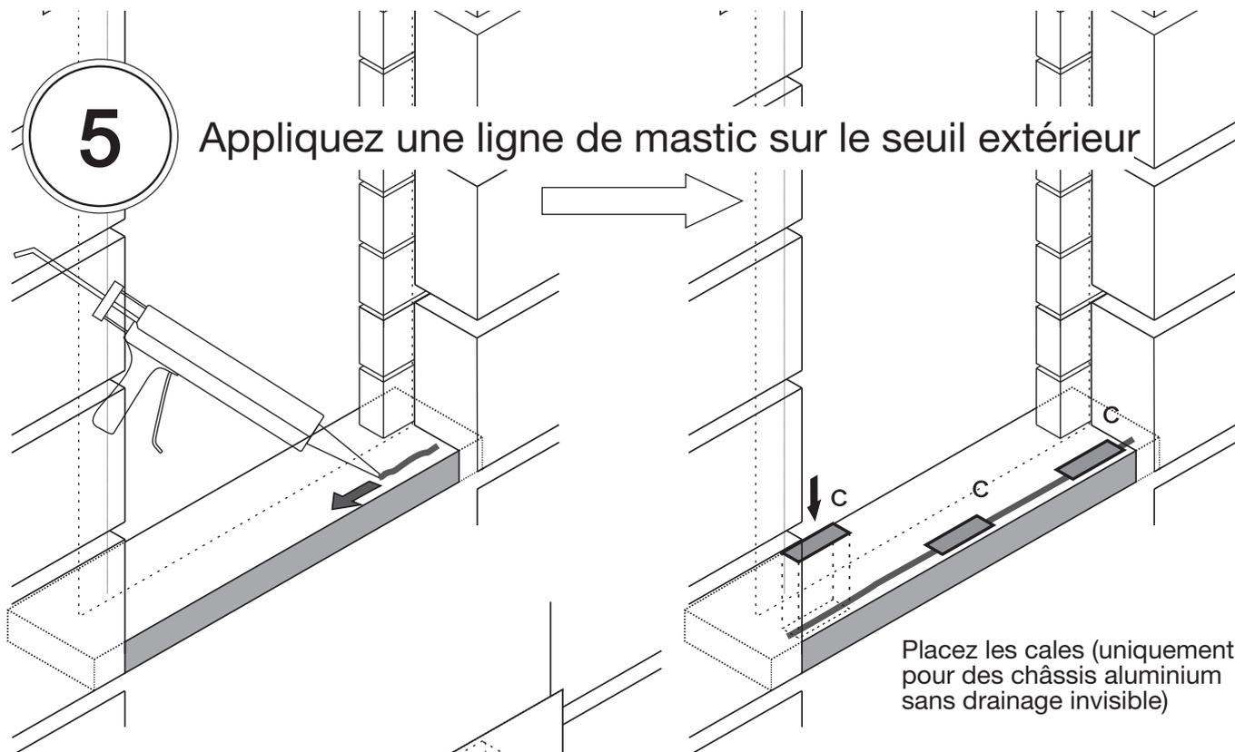
Placez les cales (uniquement pour des châssis aluminium sans drainage invisible)
