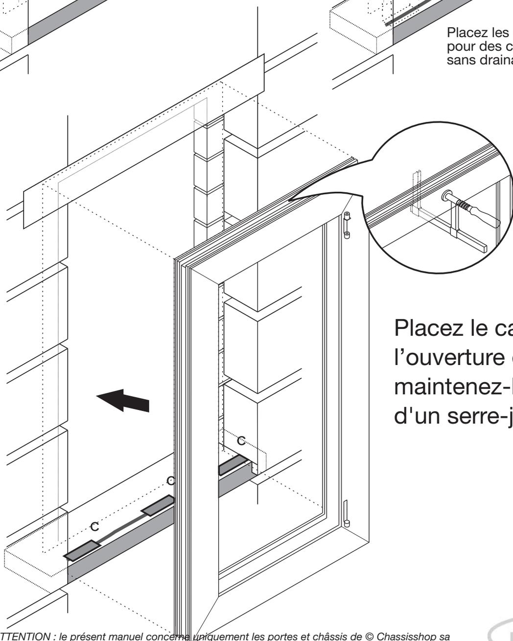
Placez le cadre dans l'ouverture et maintenez-le à l'aide d'un serre-joint
