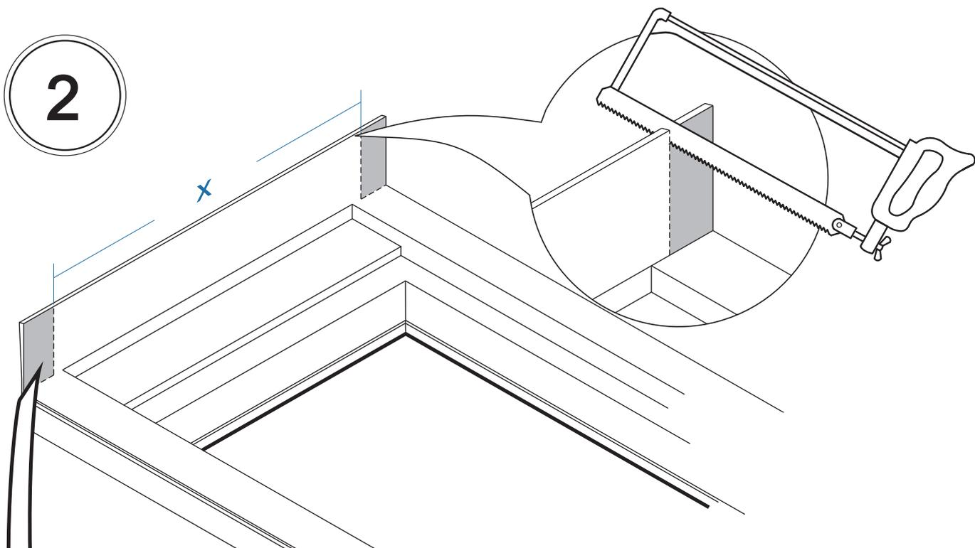
ZSciez les coins des ponts de seuil afin de les adapter à l'ouverture dans le mur extérieur
